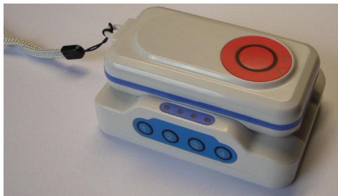
Das Bild zeigt ein GMD-x1 auf dem Ladegerät und mit eingesteckter Abreißschnur
